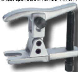
Stuurkogel trekker extra groot Extracteur de rotules à 2 positions XL opening bek : 22mm Met 2 werkposities door het verstelbare scharnier, met een maximaal spanbereik van 50 mm en van 80 mm
